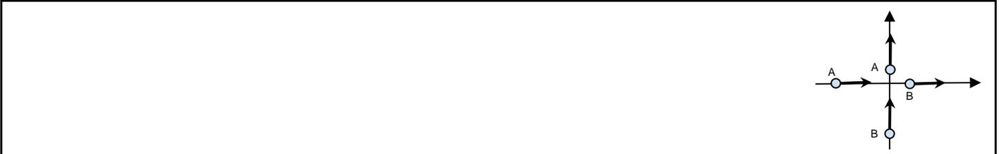
**例 3** 同じ質量  $m=2\text{kg}$  の 2 つの物体 A、B があり、物体 A は  $x$  軸正の向きに速さ  $v=10\text{m/s}$  で進み、物体 B は原点で静止していて、原点で衝突した。衝突後、物体 A は  $x$  軸正の向きから  $y$  軸正の向きにおいて  $45$  度の角度に進み、物体 B は  $x$  軸正の向きから  $y$  軸負の向きにおいて  $45$  度の角度に進んだ(ただし速さ  $0\text{m/s}$  の止まる場合も含める)。二つの物体 A、B の衝突後の速さをそれぞれ求め、2 つの物体 A、B の運動エネルギーの差が、衝突前後で広がったか縮まったか調べなさい。
